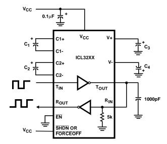
FIGURE 10. TRANSMITTER LOOPBACK TEST CIRCUIT
