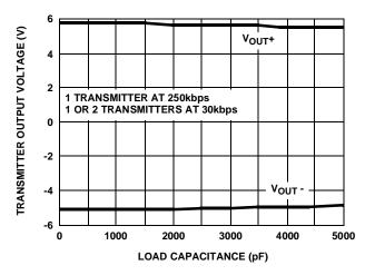
FIGURE 13. TRANSMITTER OUTPUT VOLTAGE vs LOAD CAPACITANCE
