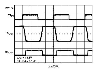
FIGURE 12. LOOPBACK TEST AT 250kbps
