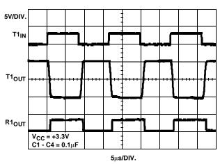
FIGURE 11. LOOPBACK TEST AT 120kbps
