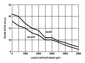
FIGURE 14. SLEW RATE vs LOAD CAPACITANCE
